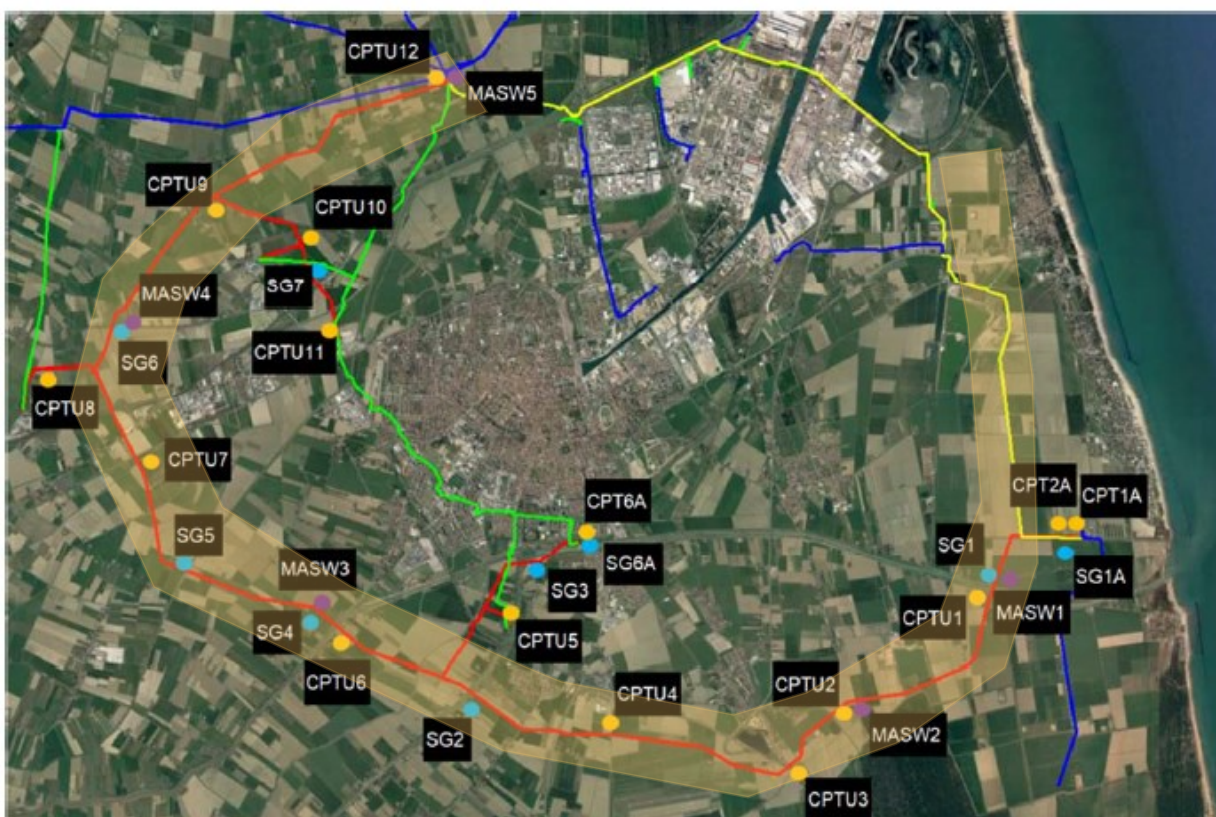
Figura 6.A – Localizzazione delle indagini svolte nell’ambito della progettazione del Metanodotto “Ravenna Terra-Ravenna Mare DN 300 (12”) DN 650 (26”) e opere connesse” (Azzurro: sondaggi; giallo: prove penetrometriche; viola: prove MASW) – nel retino in giallo l’area interessata dal Met. Collegamento PDE FSRU di Ravenna al Nodo di Ravenna DN 900 (36”), DP 75 bar.
